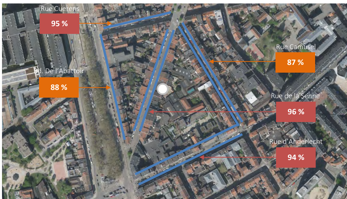
Figure 5 : Cartographie de l'état du stationnement en voirie la journée (ABO)
