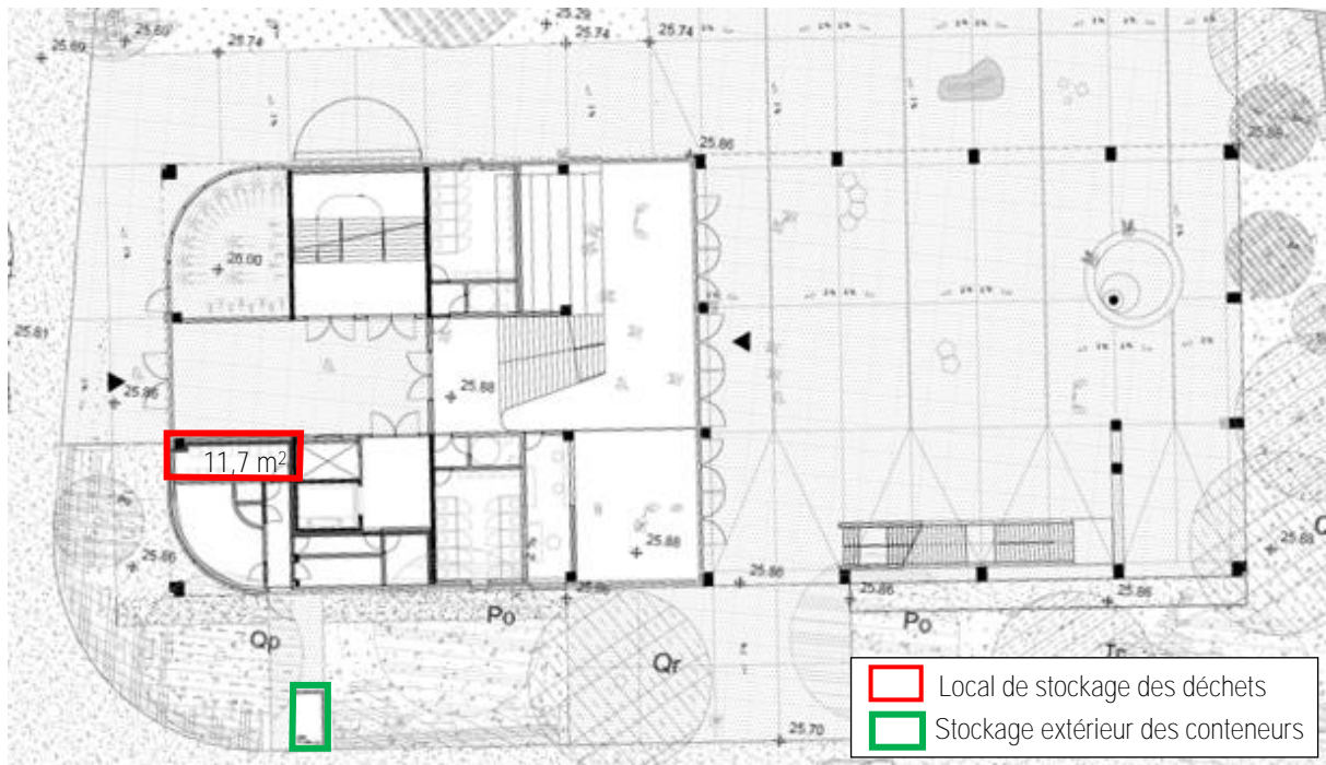
Figure 158 : Localisation local de stockage des déchets du D2-D3 (ARIES sur fond MSA, 2018)
