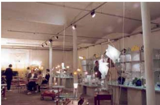
Fig. 2 : Entrepôt (1854) réaffecté comme centre communautaire De Markten. Édifié selon la construction fireproof mill typique avec des poutres et colonnes en fonte. (photo 1998).
