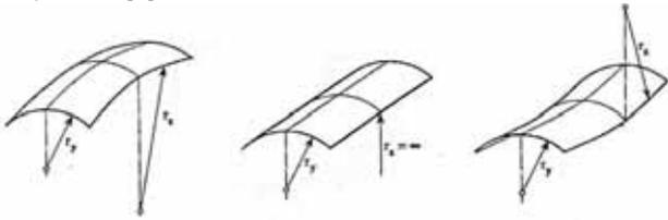
Fig. 3 : Surface à courbure gaussienne positive, négative ou nulle [9].
