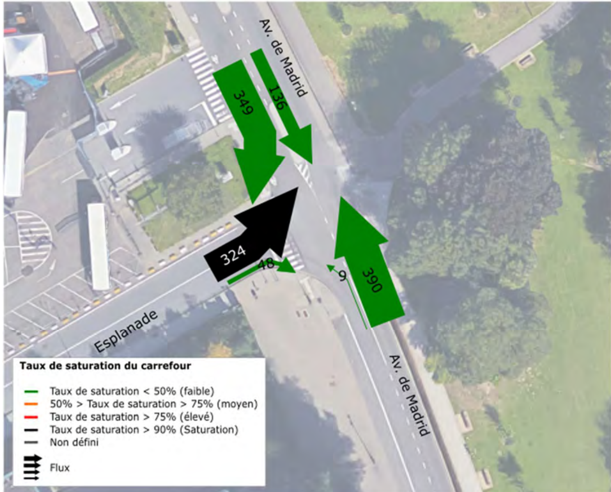
Figure 170 : Importance des flux et taux de saturation du carrefour entre l'avenue de Madrid et l'Esplanade en HPS (ARIES, 2016)
