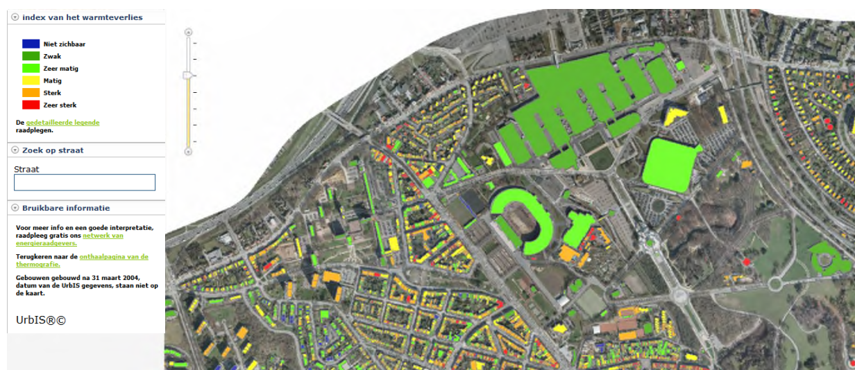
Afbeelding 193: Luchtthermografie op de site
