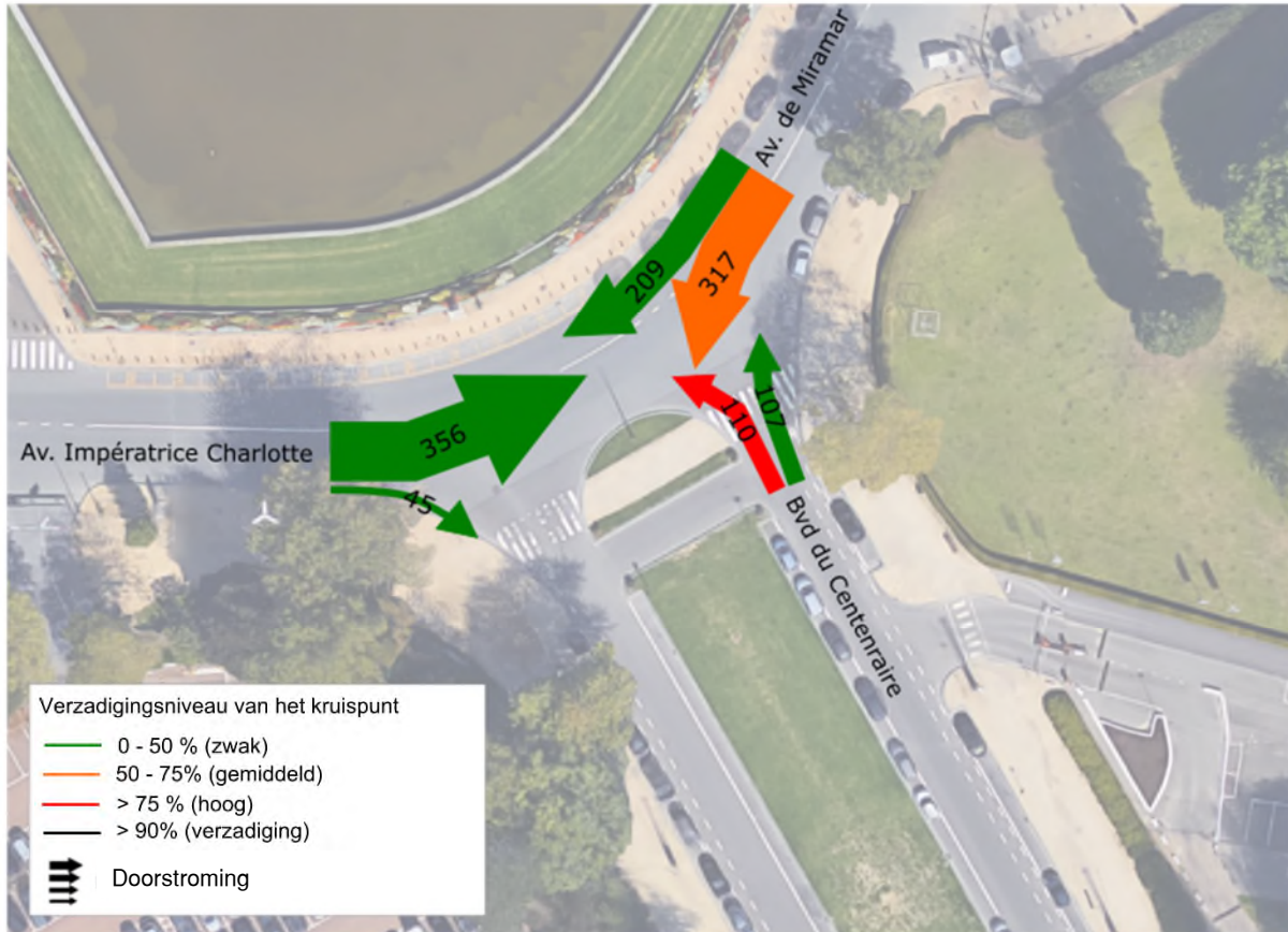
Afbeelding 162: Belang van de stromen en het verzadigingsgehalte van het kruispunt tussen de Keizerin Charlottelaan - Miramarlaan - Eeuwfeestlaan tijdens ochtendspits (ARIES, 2016)
