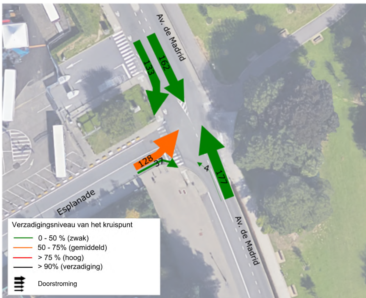
Afbeelding 176: Belang van stromen en verzadigingsgehalte van het kruispunt Madridlaan - Esplanade tijdens de zaterdagspits (ARIES, 2016)
