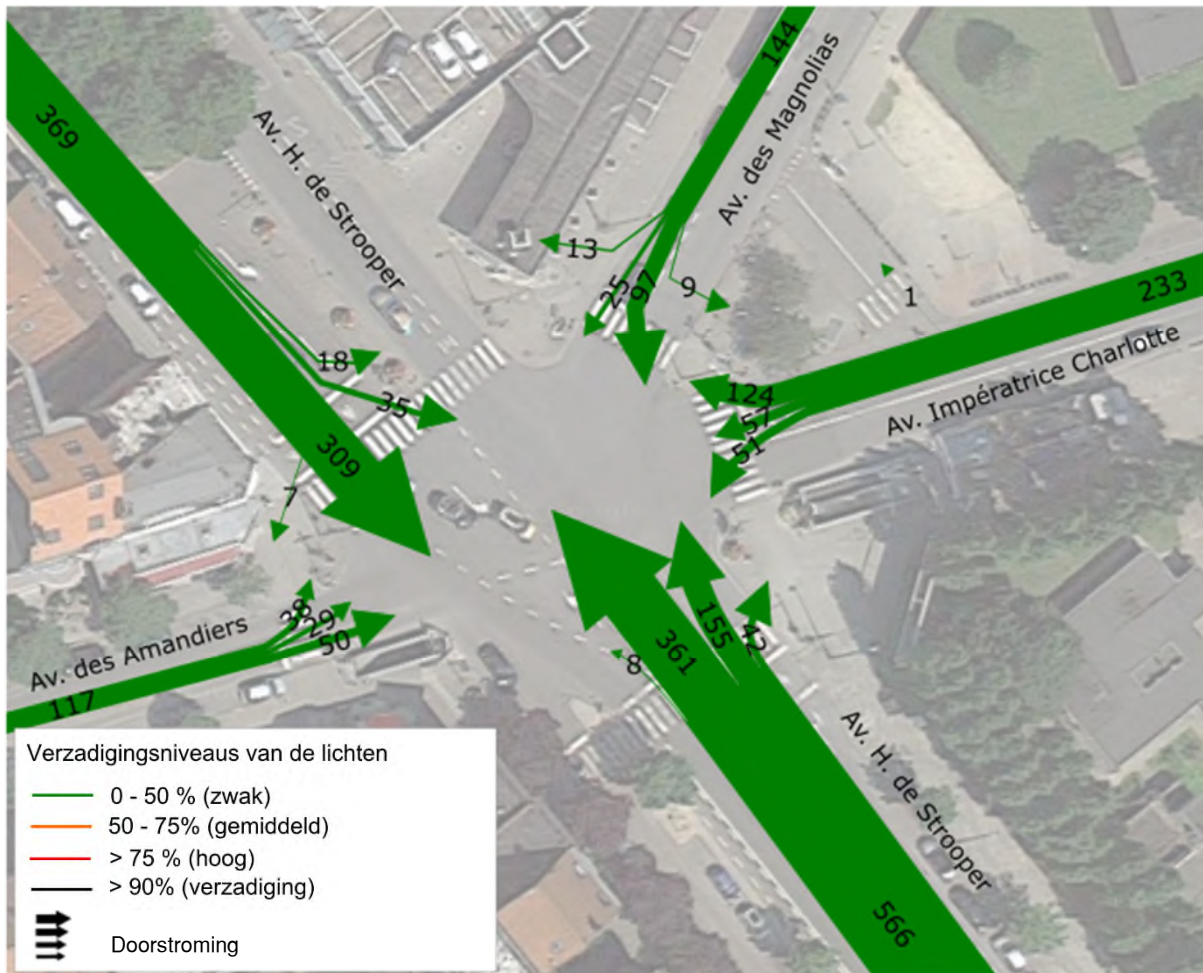
Afbeelding 167: Belang van de doorstroming en de verzadigingsniveaus van de lichten in HPS op het kruispunt tussen de Houba de Strooperlaan - Keizerin Charlottelaan - Magnoliaan - Amandelbomenlaan (ARIES, 2016)
